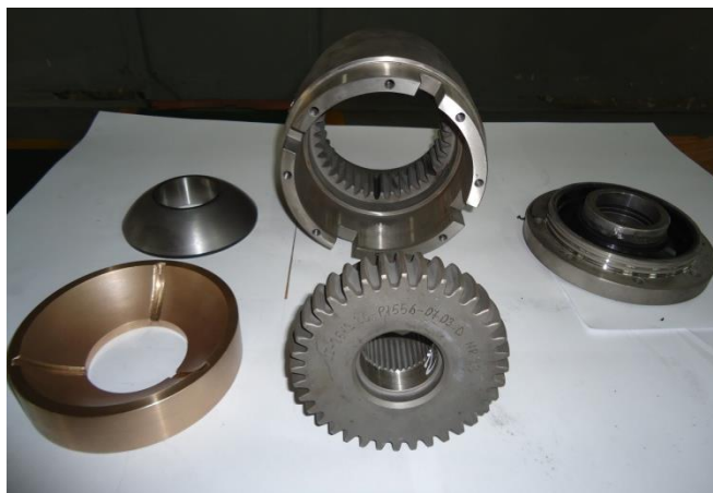
Fig.2 Componentele principale ale cuplajelor dințate ale pompelor PCP
